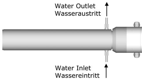
In order to fill the entire water cooling jacket, incoming water must enter from the bottom. Damit sich die Wasserkühlung vollständig mit Wasser füllt, muss der Wasserzufluss von unten erfolgen.
